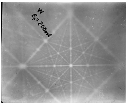
Рис.2. Одна из первых протонограмм, полученных на кристалле вольфрама с помощью фотопластинки с ядерной фотоэмульсией.
