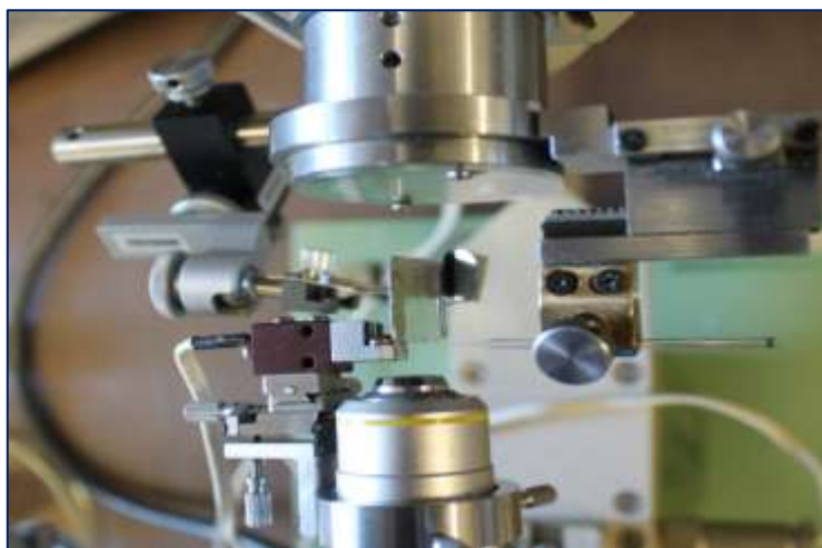
Рис. 16. Зона изготовления окна в Microforge MF-900
